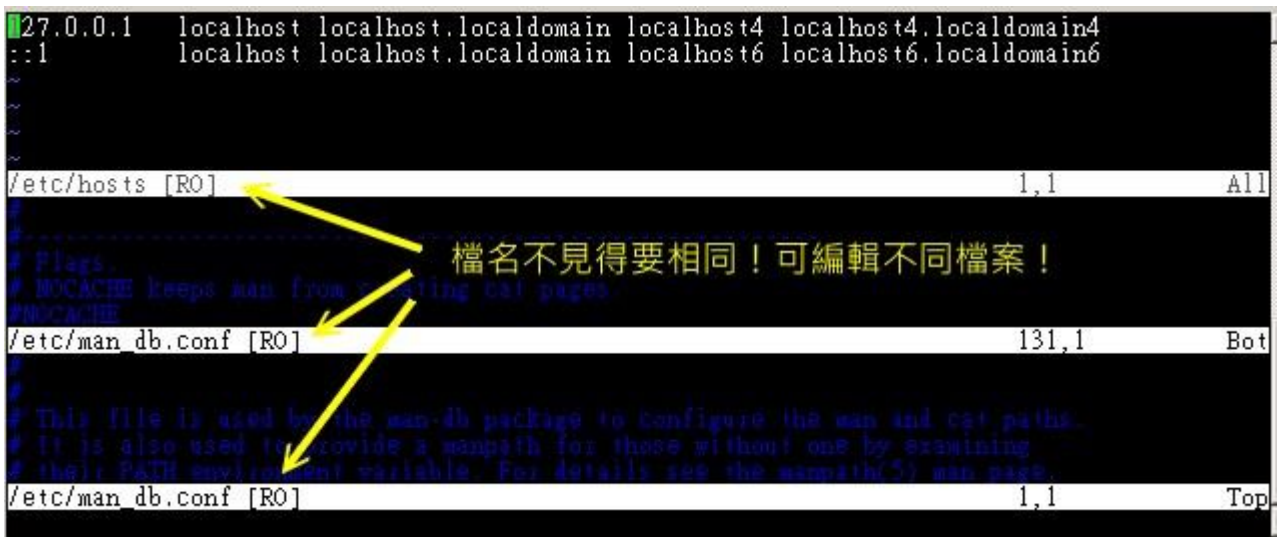
图 9.3.8、vim 的窗口分区示意图
