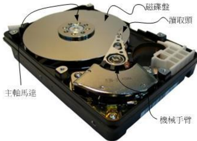
图 0.2.4、硬盘物理构造(图片取自维基百科)
